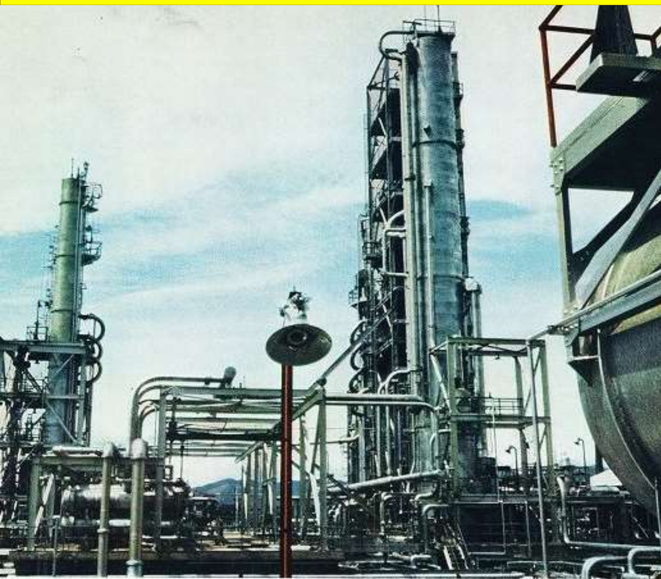
上記完成した四日市製油所原油蒸留装置 写真は完成後の同所
